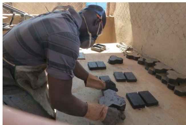
Fabrication des pavés autobloquants
